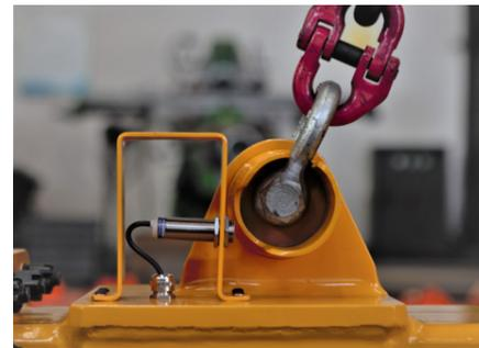
Sistema de detección de aterrizaje con interruptor de proximidad inductivo contra desmagnetización accidental en el aire
